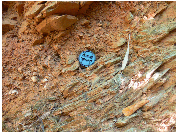
รูปที่ 7.20 รอยต่อระหว่างชั้นหินและ Colluviums เป็นบริเวณที่มักเกิดแนวการเคลื่อนพังของลาดดิน เนื่องจากแรงดันน้ำใต้ดินมักมีค่าสูง ภาพจากพื้นที่น้ำท่วมดินถล่ม ต.แม่พูล อ.ลับแล จ.อุตรดิตถ์
