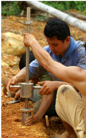
รูปที่ 7.19 ตัวอย่างบ่อสำรวจ Test Pit ในดินเชิงพา Colluviums และ Residual Soils และ การเก็บตัวอย่าง โดยกระบอกเปลือกบางชนิด KU-Miniature Sampler ในบ่อสำรวจ (วรากรและคณะ, 2550)
